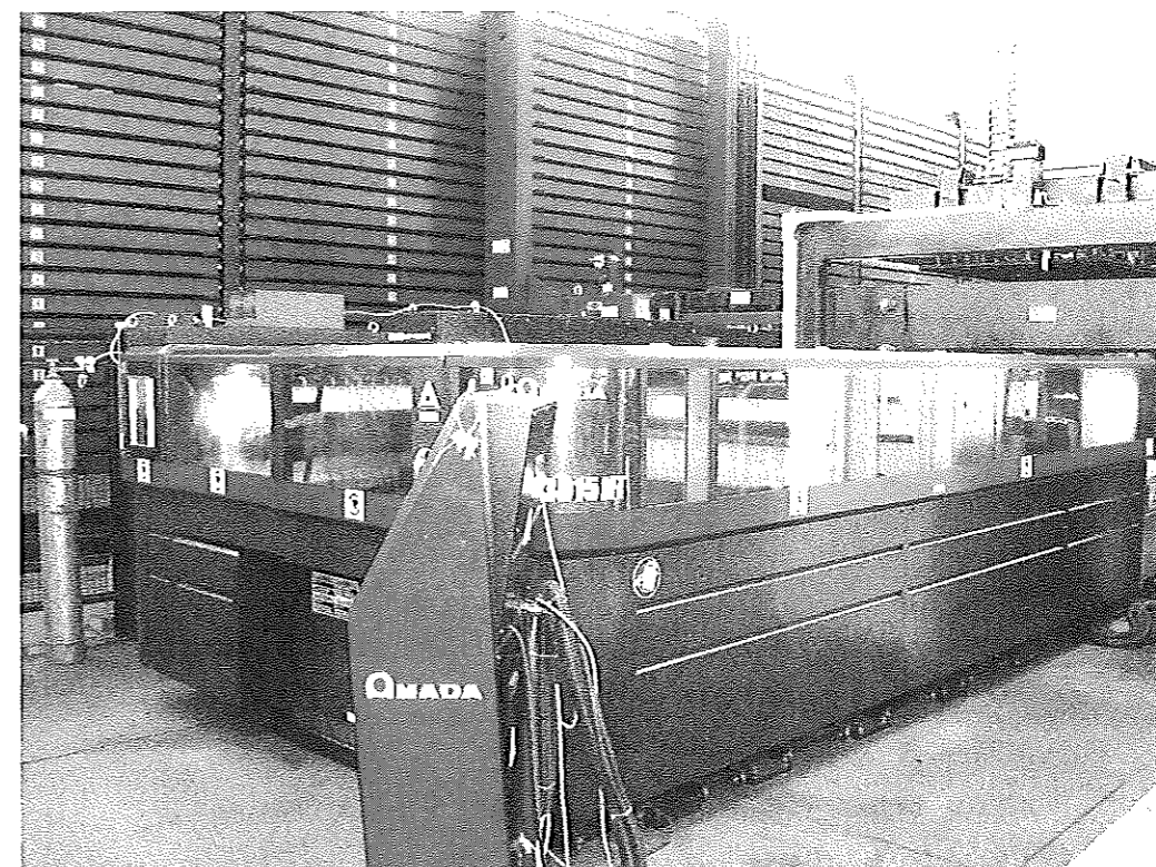
Il sistema di taglio laser Amada FOL-3015 NT a motori lineari installato presso le Officine Pollastri in linea con il magazzino centrale di stoccaggio dei materiali centrale.
